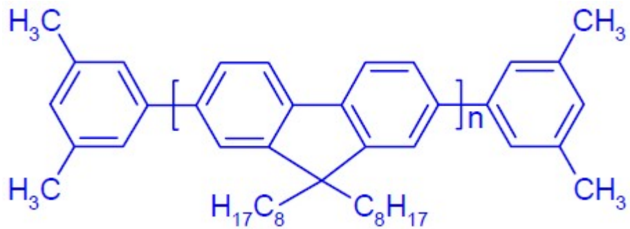
圖 2-1.3: 有機共軛高分子材料PF0簡式及其共軛長鏈示意圖
